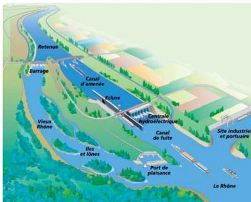
Schéma de l'aménagement type d'une usine hydroélectrique CNR. - Source : CNR
